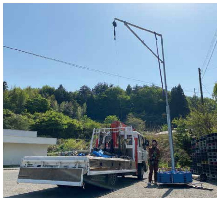
重量固定タイプ(可搬式) 高さ:6.5m 突梁:2.5m 重量:1.5t
